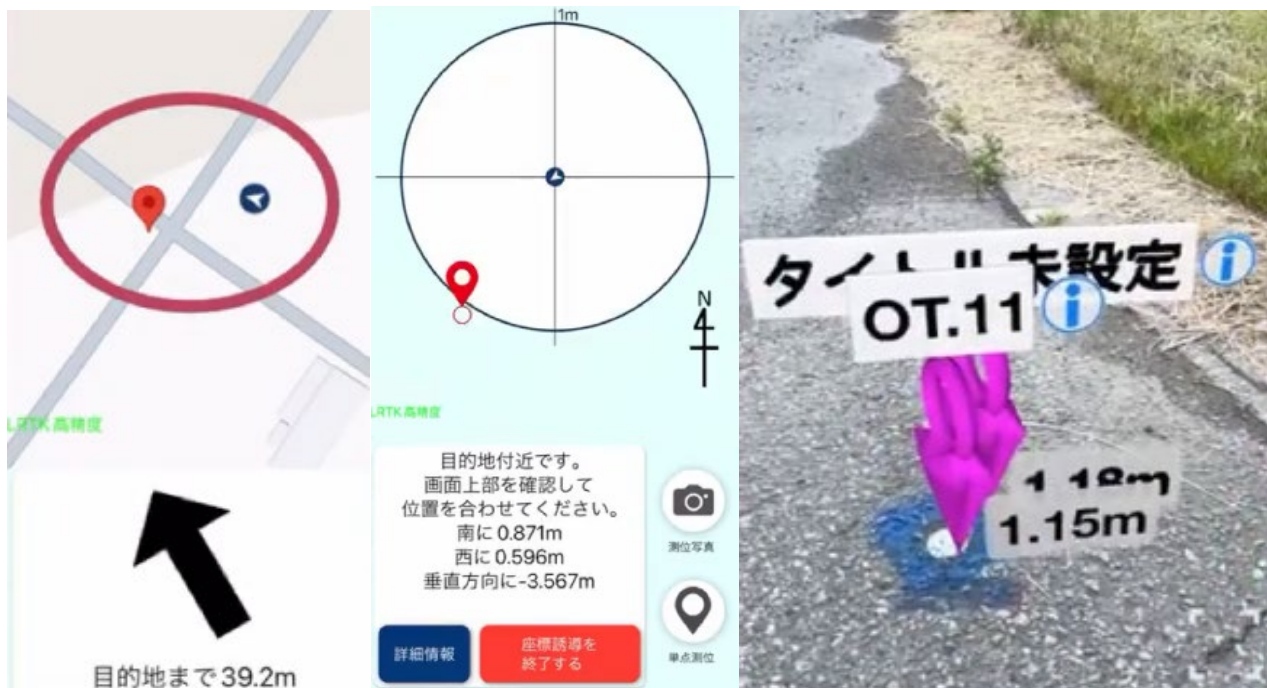
図 6 LRTK アプリ画面：目的地までの距離や方位を表示。AR で杭位置をナビゲーション
