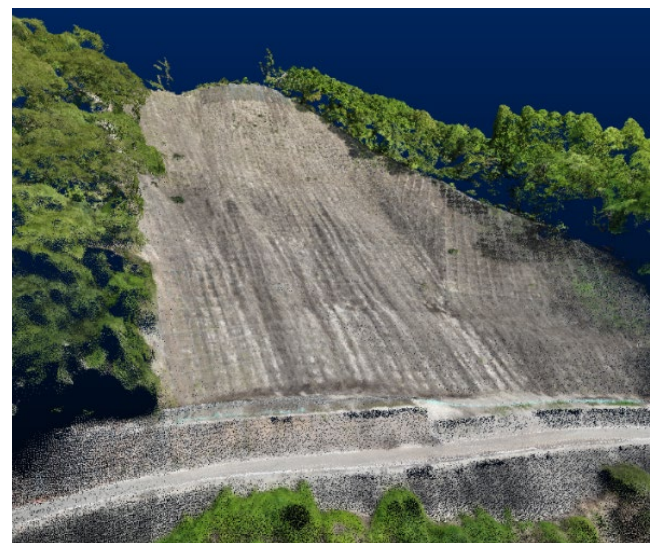
図 7 LRTK で取得した大規模法面の 3D 点群
