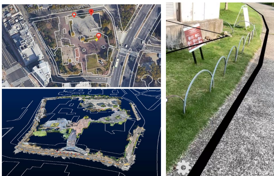
図 5 DWG/DXF を GIS マップへ重ね合わせて現場で図面を AR 投影している様子
